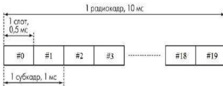
2.5 сурет – LTE кадрлық құрылымы кезінде дуплекстік жиіліктік бөлуарналары
